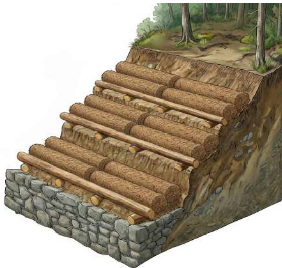
3. Colocación de biorrollos de fibra de coco para proteger el suelo y facilitar la revegetación.
