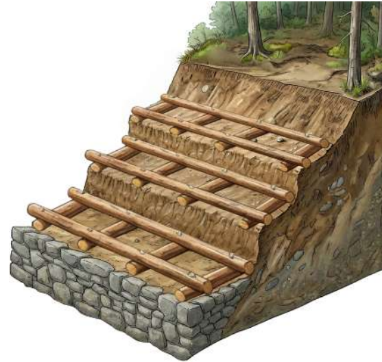
2. Estabilización del talud con estaquillado y estructuras de madera.
