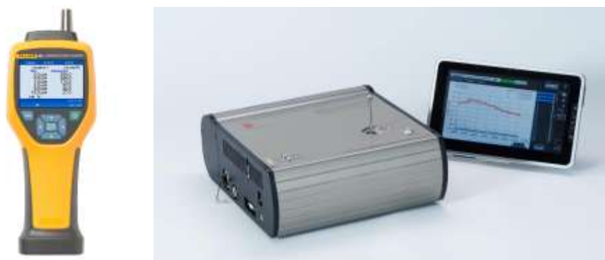
Figura 6. Equipos contadores de partículas empleados en el Proyecto. FLUKE 985 para muestreos periódicos manuales (izquierda) y Mini-Wras 1371 (derecha) empleado para validaciones periódicas en campo.
