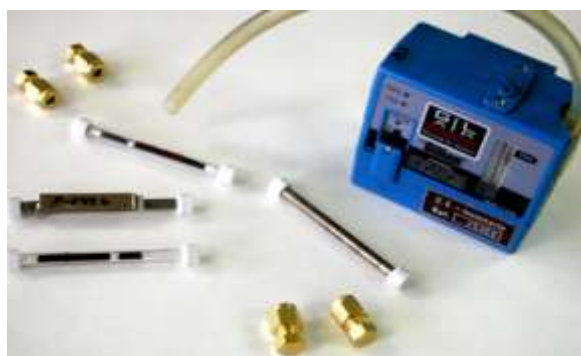
Figura 5. Bomba de succión empleada para el muestreo del aire y ejemplo de los tubos adsorbentes empleados.
