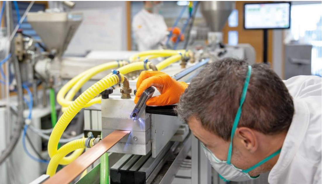
Figura 5. Obtención de perfiles de PVC por extrusión, incorporando tiesto de cocción roja como carga mineral. (Fuente: SAXUN – Giménez Ganga)
