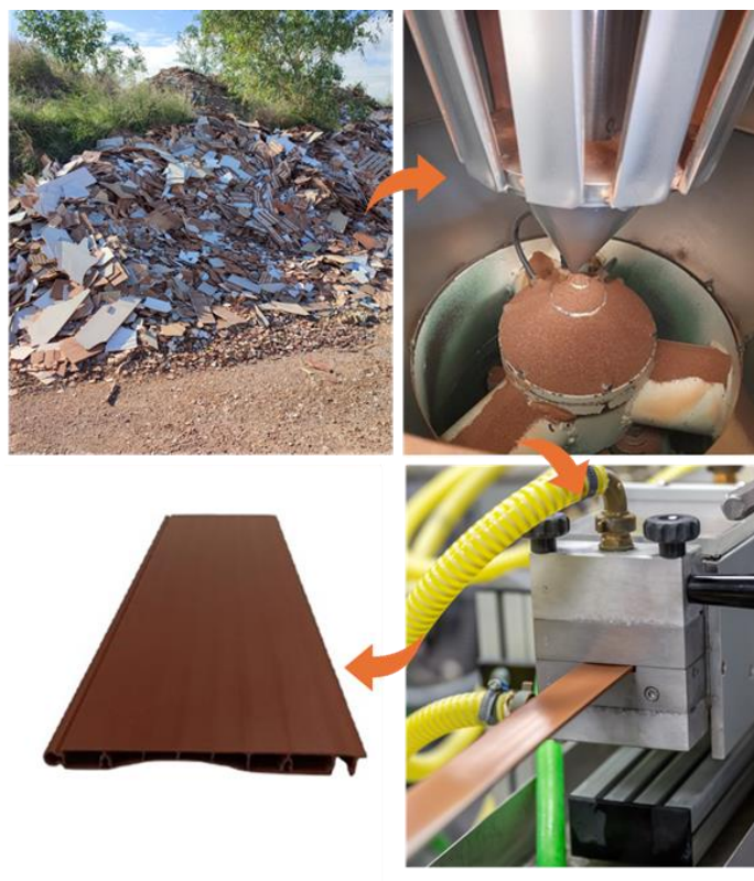
Figura 1. Esquema de valorización del tiesto cerámico en la industria del plástico.
