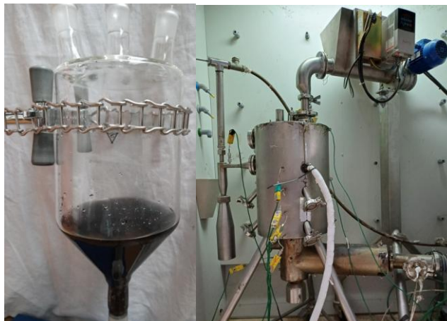
Figura 2. (a) Foto del reactor spouted bed cónico a escala de laboratorio, (b) Foto del reactor spouted bed cónico a escala de planta piloto.
