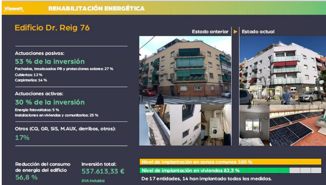
Figura 4: Ejemplo de uno de los edificios rehabilitados con el proyecto Vilawatt-UIA
