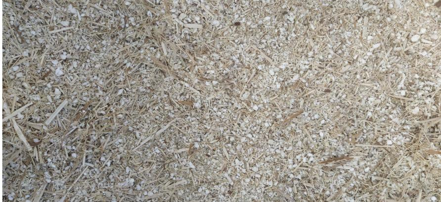
**Figura 8.** Biomasa de tallos de girasol triturada en molino de cuchillas (tamaño menor de 1 cm)
