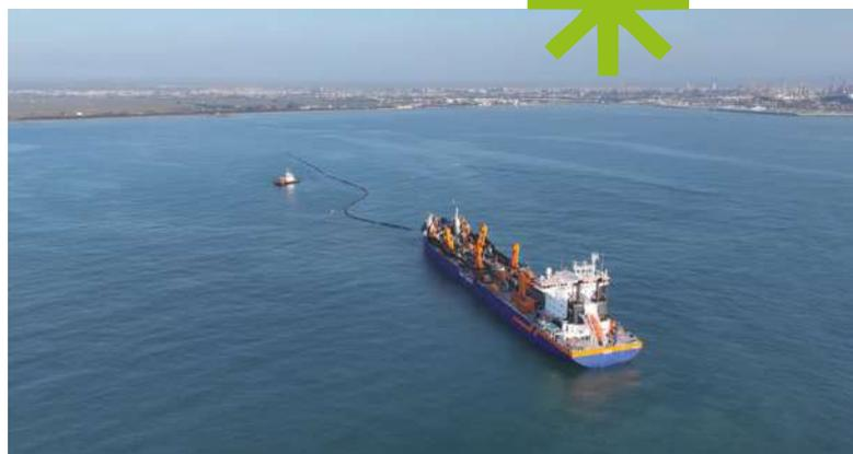
La draga de succión HAM 318 y la tubería flotante que la conecta con la playa y aporta el material captado en el yacimiento Cullera-Sueca.
